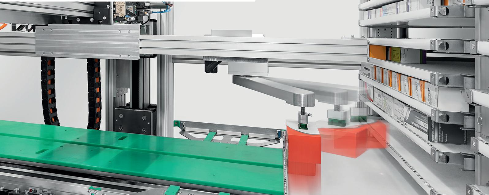
Beim **SMART-FLEXDEPOT** wird die komplette Schublade als Lagernutzfläche ausgefüllt. Alle Lagergüter verfügen über einzelne Lagerplätze und können durch einen direkten Zugriff schnellstmöglich ein- und ausgelagert werden - **somit entfällt aufwendiges Umlagern.**
