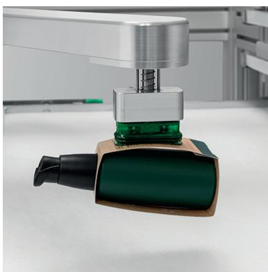
Durch eine exakte 3D-Vermessung im Einlagermodus wird die Form der Produkte erfasst und die bestmögliche Greif- und Ablageposition bestimmt.
